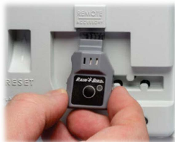
Es un modulo compatible con controladores **“ESP-TM2”** y **“ESP-ME”** que introduce mejoras para que puedan ser accesible y programables al controlador desde dispositivos iOS y Android, **funciona como control remoto y sistema de monitoreo**, cuenta con notificaciones móviles con acceso a solución de problemas y permiten ajustes automáticos según el pronóstico del clima.
